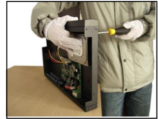
③ Fixe o disco rígido com parafusos
