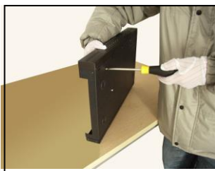
④ Aperte o parafuso do disco rígido
