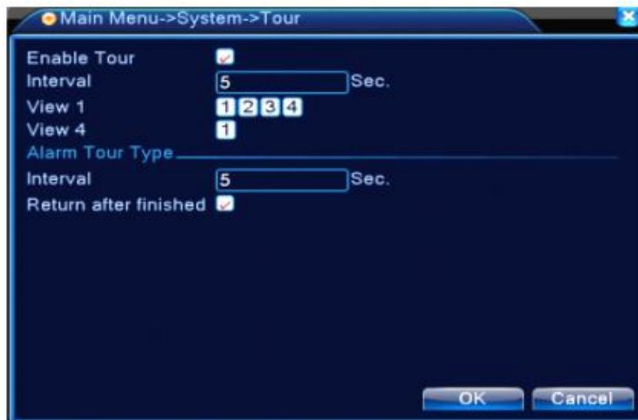
*Figura – Configuração de Sequenciamento*
