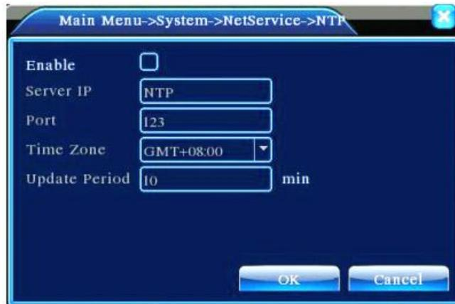
Figura – Configuração de NTP
