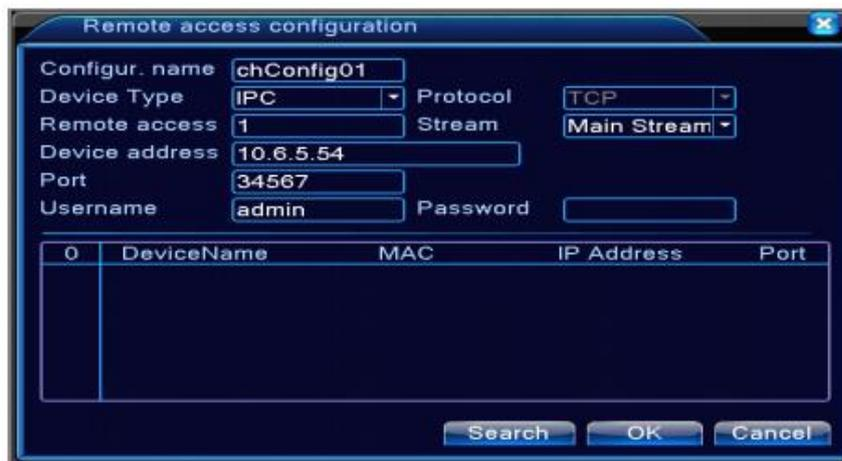
Figura – Configuração de como encontrar e adicionar uma câmera IP
