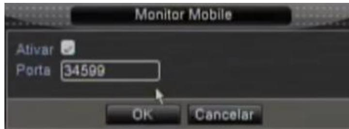
Figura 5.23 Configuração do monitor Mobile
